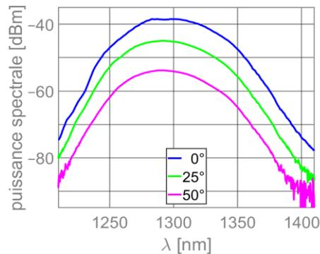
Fig. 3 : Spectres optiques mesurés dans le plan perpendiculaire à 3 angles différents
